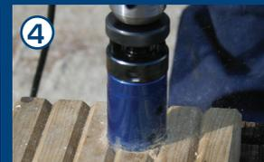
(4) POUR TOUTS LES AUTRES MATÉRIEL UTILISEZ LE AUTO-PILOT ET METTEZ DANS UN ADAPTATEUR STANDARD. CELUI-CI VA PÉNÉTRER DANS LE MATÉRIEL ET GUIDER VOTRE SCIE CLOCHE.
