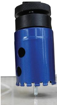
AUGMENTER GRADUELLEMENT LA PUISSANCE POUR FORMER LE TROU DE FORAGE
